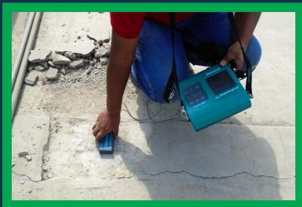
Escaneo de acero de refuerzo en vigas
