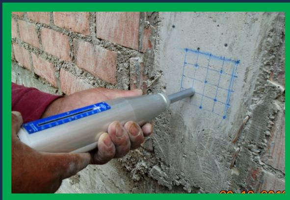
Ensayo de esclerometría en columnas
